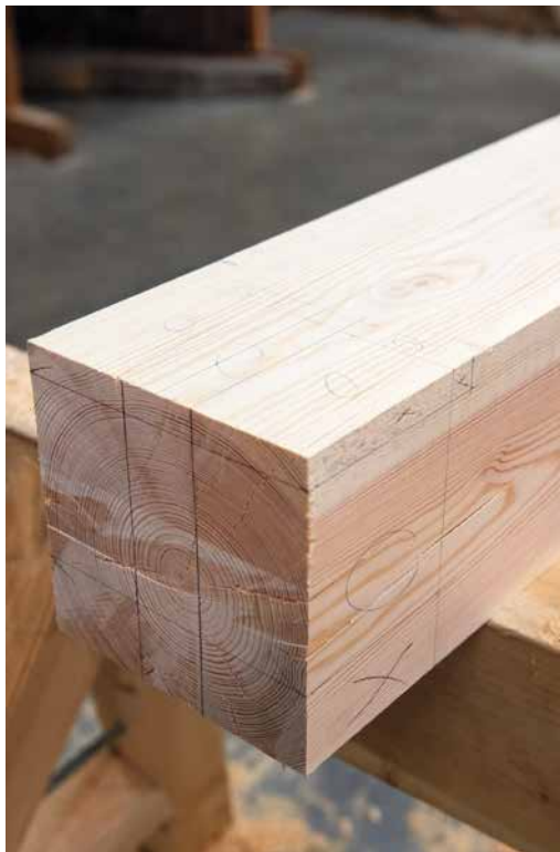
Illustratsioon 43. Märgitud pruss enne lõikamist.
