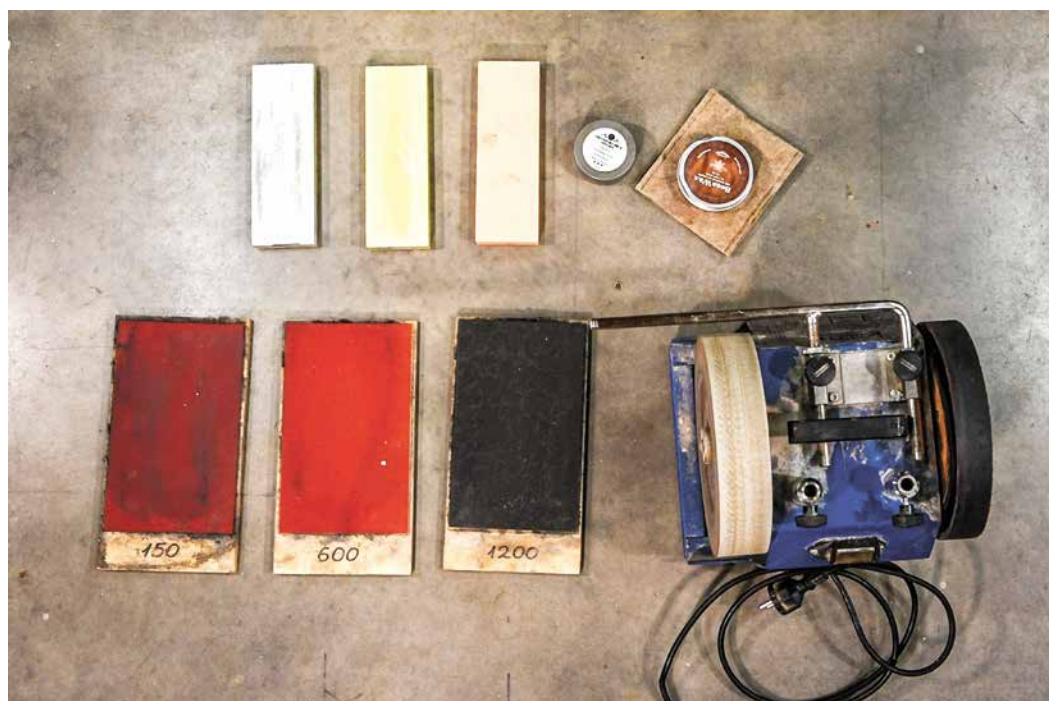
Illustratsioon 19. Teritamisvahendid: terituskivid, liivapaberid, terituskäi.
