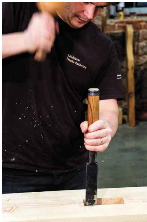
Illustratsioon 47. Tapipesa ette puurimine ja peitliga välja lõikamine (B).
