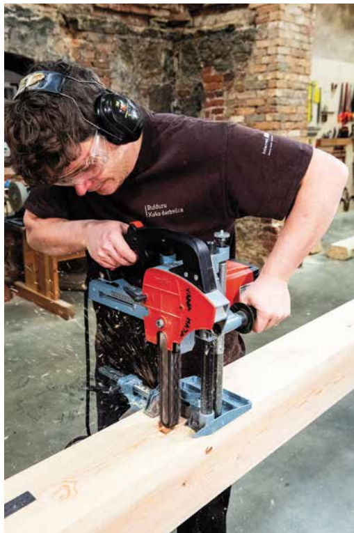
Illustratsioon 46. Tapipesa freesimine tapifreesiga (A).
