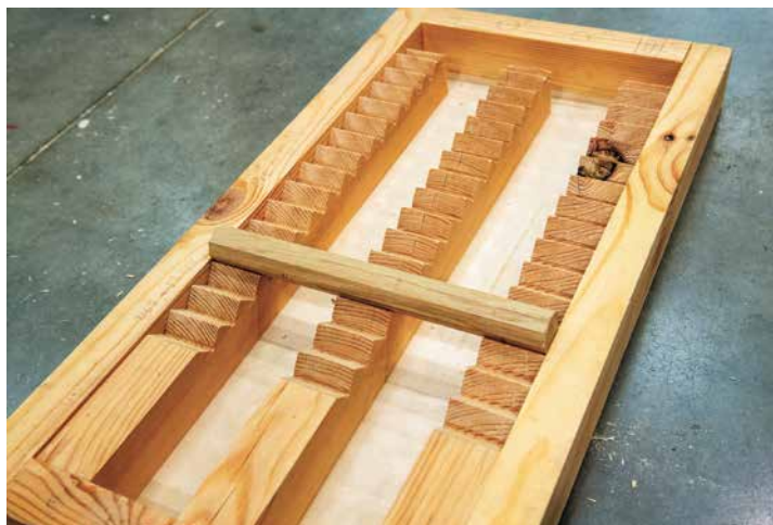
Illustratsioon 36. Lihtne kaheksanurkse naagli tegemise rakis paksusmasi- nast läbi laskmiseks.
