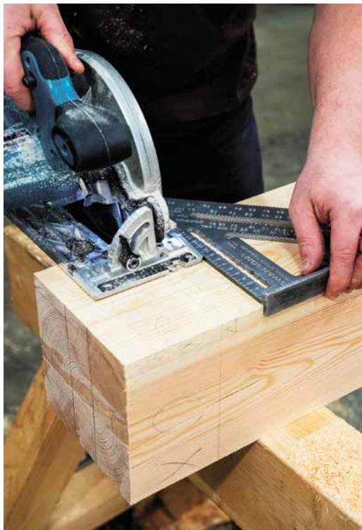
Illustratsioon 21. Ketassaega saagimine kiirnurgiku abil.
