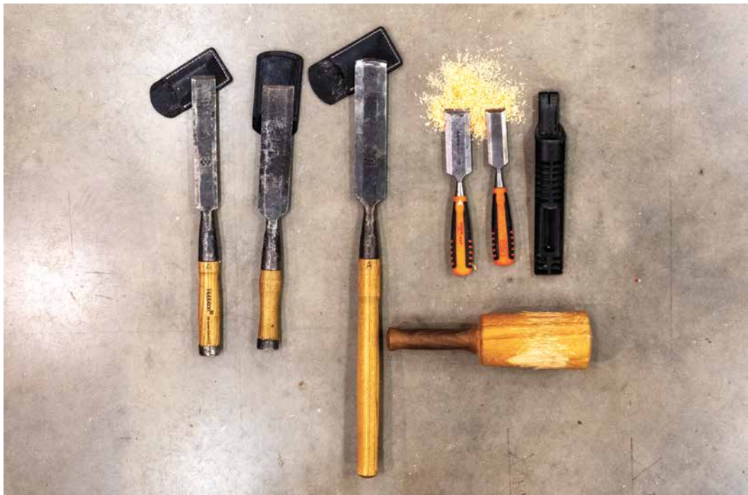
Illustratsioon 27. Kaks sepistatud peitlit (sõrmusega), pika varrega viimistluspeitel, kaks Bahco peitlit, puuhaamer.
