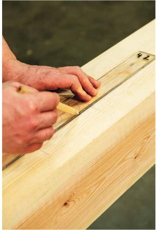
Illustratsioon 23. 42 mm laiune pleksiklaasist šabloon tapipesa märkimiseks.
