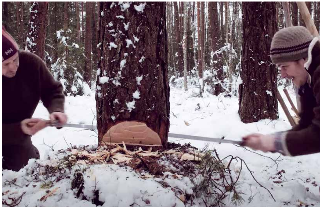
Illustratsioon 8. Puu langetamine traditsioonilisel meetodil.
