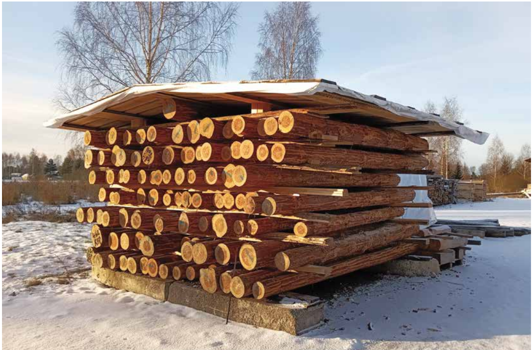
Illustratsioon 15. Staabeldatud ehituspalk looduslikult kuivamas.
