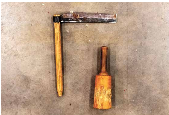
Illustratsioon 35. Lõhestamiskirves, puuhaamer.
