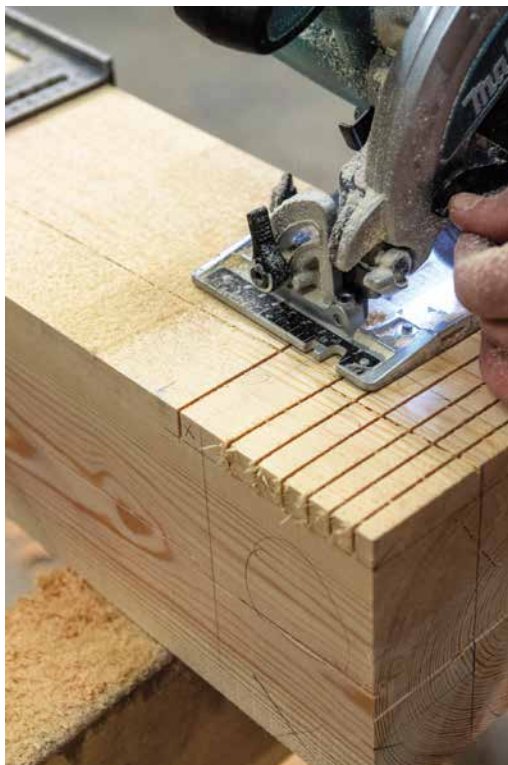
Illustratsioon 44. Viilutatud tasanduspesa (A).
