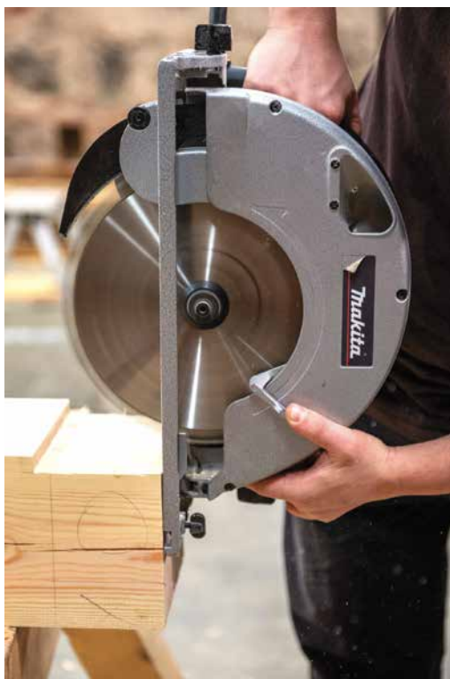
Illustratsioon 45. Keele lõikamine langeva lõikega (B).
